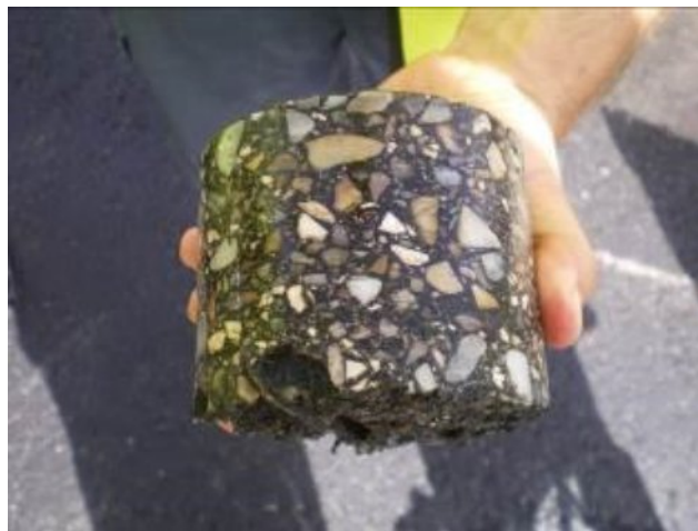
Foto 3: Testigo de obra con MTRE a tasa total
